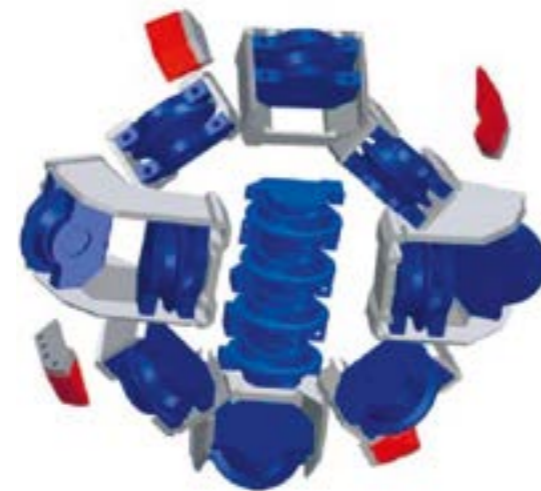
Рабочий орган щита TBM 1200 для проходки скальных пород. Расположение режущих инструментов
