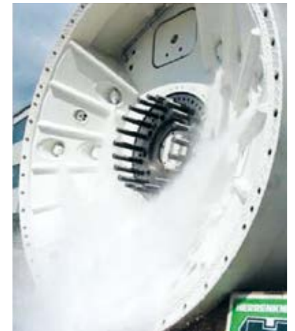
Испытания форсунок среднего давления
