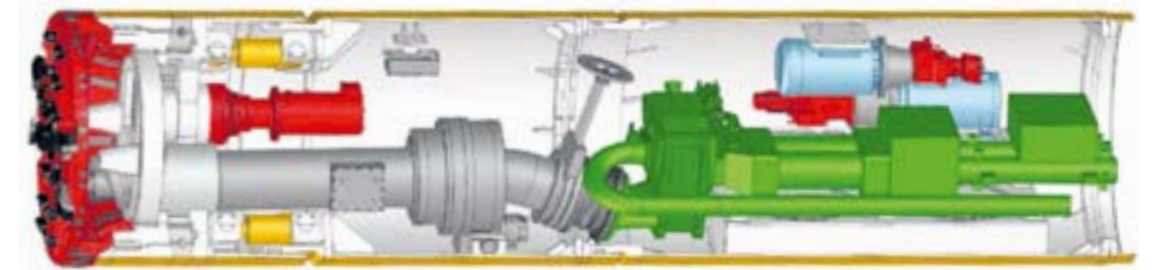
Продольное сечение щита с грунтовым пригрузом и насосной подачей
