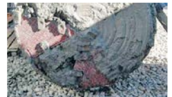
Налипание грунта на рабочий орган (форсунки среднего давления не используются)
